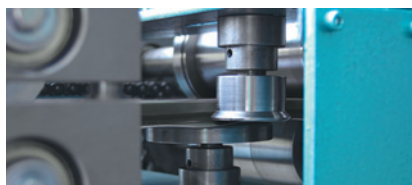
Промежуточные задаю- щие вертикальные ролики
