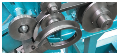
Готовое кольцо на выходе станка
