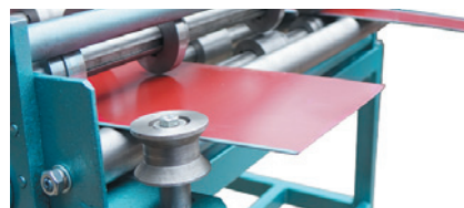
Завальцованная с одной стороны полоса
