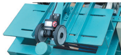
Задающий стол с регулируемыми направляющими
