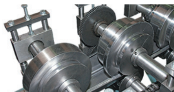
Шестеренки для передачи момента на верхний вал
