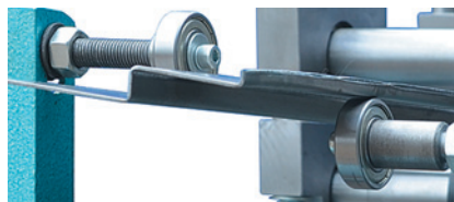
Калибрующие ролики для настройки прямолинейности профиля
