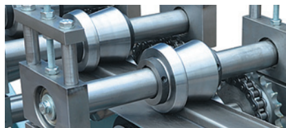
Ролики из легированной конструкционной стали
