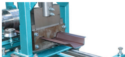
Фасонная 3-D гильотина с пневматическим приводом (летучий рез)
