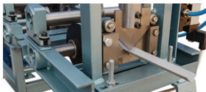
Фасонная гильотина (стационарный рез)
