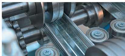
Вертикальные промежуточные ролики
