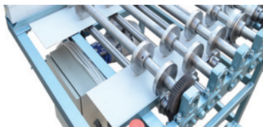
Регулируемые направляющие позволяют менять размер крайних элементов профиля
