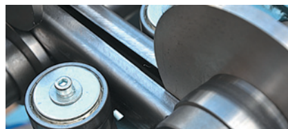
Промежуточные задающие вертикальные ролики
